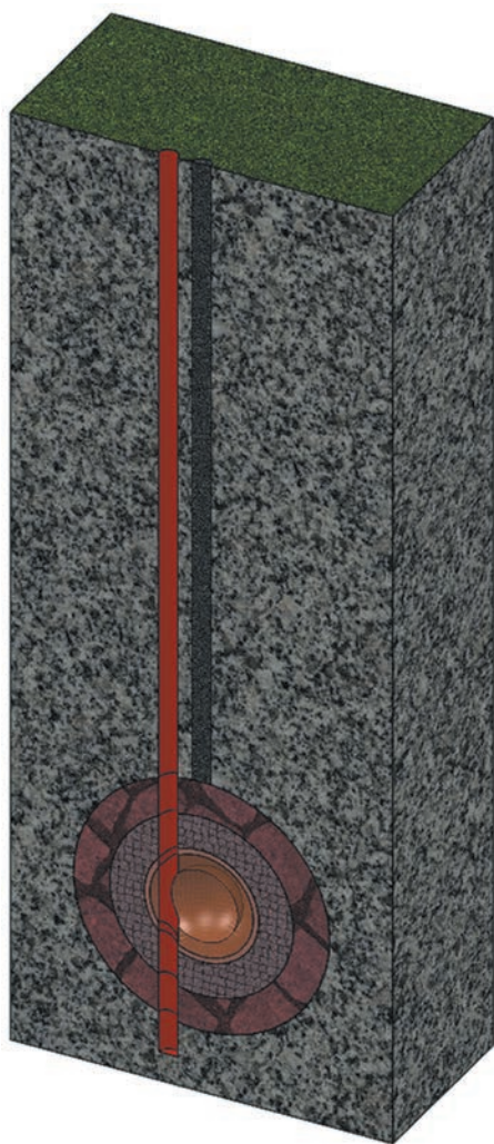
Рис. 1. Вскрытие котловой полости направленным бурением скважины
